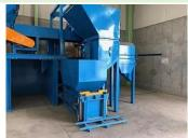
空き缶、空き瓶、PETボトル等を人手で選別し、空き缶は磁選機にてアルミ缶とスチール缶に分類し各々圧縮処理する施設。圧縮処理後の空き缶は、鉄及び非鉄金属回収問屋へ搬出。スチール缶は、主に鉄筋等の建築資材へ、アルミ缶は、主にアルミ缶へリサイクル。空き瓶は、カレットメーカーへ搬出しリサイクル。PETボトルは、次工程へ(粉砕機で処理)。
