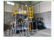
破砕処理の石膏ボート及び ALC 等を造粒固化する施設。処理後の造粒固化物は 粒度を 40mm 以下に調整。再生砕石 (RC40-0) として伊奈平工場で販売。
