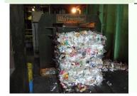
多種多様な廃プラ類を破砕処理し、用途に応じ選別 (A・B・C ランク) する施設。一次破砕後に選別ラインを(振動篩機、手選別ライン、磁選機)を設置し、高精度選別機械(風力・比重差選別)、次工程ではロータースクリーンにて選別。各種リサイクルにおける禁忌品を徹底分別し、良質なプラスチックを搬出先に提供。処理後の廃プラ類は、圧縮梱包施設における工程を経て、主にセメントメーカー・製紙メーカーへ搬出。東京都廃プラ埋立ゼロ協定に対応し、ほぼリサイクル可能にした。
