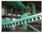
多種多様な廃プラ類を破砕処理し、用途に応じ選別 (A・B・C ランク) する施設。一次破砕後に選別ラインを(振動篩機、手選別ライン、磁選機)を設置し、高精度選別機械(風力・比重差選別)、次工程ではロータースクリーンにて選別。各種リサイクルにおける禁忌品を徹底分別し、良質なプラスチックを搬出先に提供。処理後の廃プラ類は、圧縮梱包施設における工程を経て、主にセメントメーカー・製紙メーカーへ搬出。東京都廃プラ埋立ゼロ協定に対応し、ほぼリサイクル可能にした。
