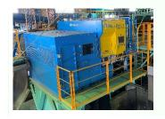
近赤外線を利用した廃プラスチック類の選別装置。塩素濃度が高い廃プラスチック類とその他の異物を AI が近赤外線センサーで識別し、エアーを利用して選別する。選別後の良質な廃プラスチック類は製紙メーカーやセメント工場の代替燃料としてリサイクルされる。
